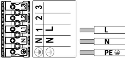
(EMG/EM3 wiring / verdrahtung)
